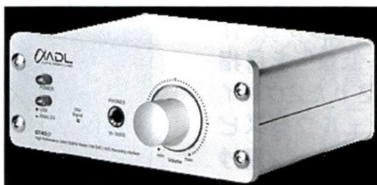
最高192kHz/24ビットまでの録音&再生に対応するUSB-DAC. ADC/DACチップにCS4270を搭載. フォノ (MC, MM) を含めたアナログ入力をデジタル化し, USBケーブルを介したPCで録音することができる. 3ステップの録音用アッテネーターを装備. フォノイコライザーとしても使用可能だ. 低ジッタークロックリカバリーシステムを搭載. ヘッドフォンアンプを含め, 各部オーディオ用パーツを投入している.
